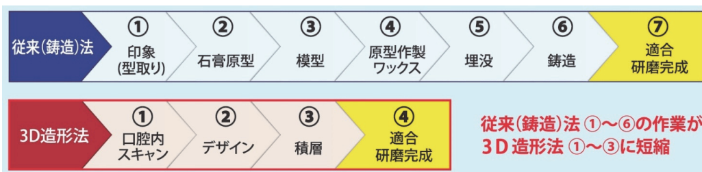
図3 従来の鋳造法と3D造形法との工程の違い
