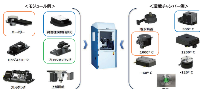
Fig.2 多機能摩擦摩耗試験機例 5) 「モジュール」と「環境チャンバー」の組合せにより、1台でさまざまな摺動形態や環境下での試験が可能である。現在は、回転&1000℃高温、高速往復&500℃高温、ブロックオンリング試験に対応している。
