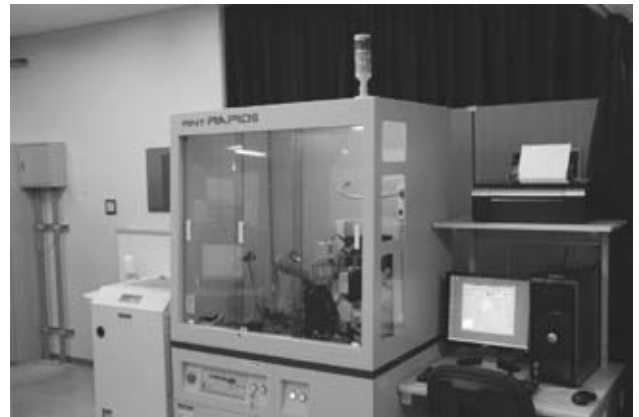
図1. 湾曲IP X線回折装置の外観
