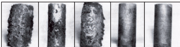
図10 加熱炉環境下(暴露)における高温腐食後の外観
