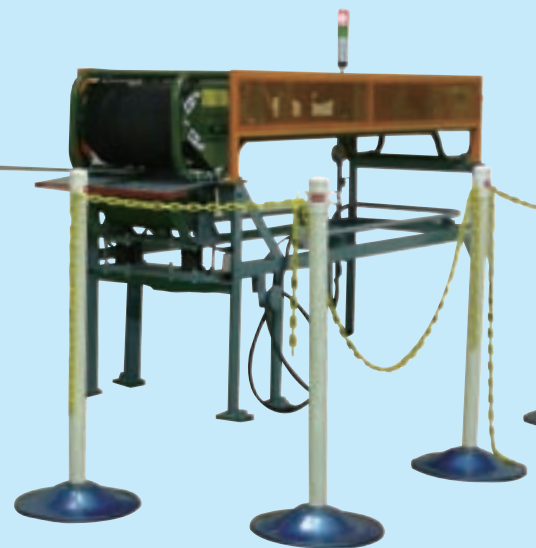
ベルトコンベアのローラーに巻き込まれたときの状況を体感
