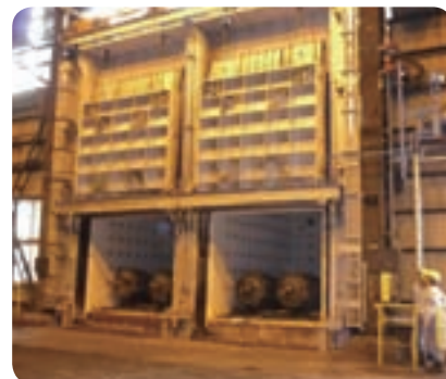
リジェネレーティブバーナーシステムを採用した自由鍛造用加熱炉
