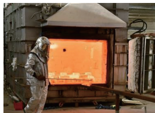
水素による鋼片加熱テストに成功したOvako Hofors工場のピット炉
