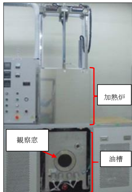
【図2 油焼入れ実験装置の外観】
