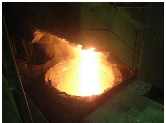
■150 t 電気炉から取鍋への出鋼の様子
