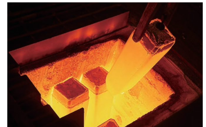
水素による圧延前鋼材加熱の実証に世界で初めて成功
