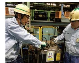
技能伝承の様子(渦流探傷機セット替え作業)
