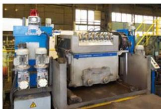
フェイズドアレイ超音波探傷機
