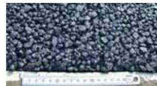
電気炉スラグ骨材を使用した排水性舗装事例
