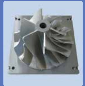
テストピースおよび実機相当部品の造形試作例
