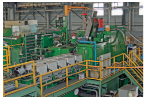
横型高速鍛造機 High-speed horizontal type forging press
