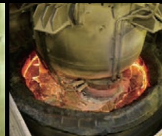
RH真空脱ガス設備
