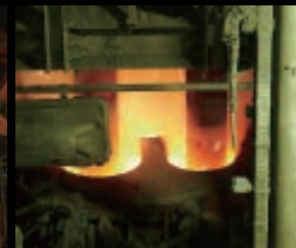
取鋼精錬設備 [LF]
